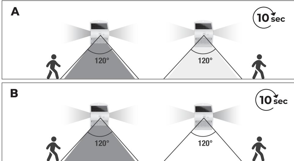
**IT - MODE A** (Premendo il tasto di accensione una volta): si accende automaticamente a piena luminosità (220lm) al rilevamento nel raggio di 2-6 metri, per poi tornare, dopo 10 secondi, alla modalità standby al 10% di intensità luminosa (emissione anteriore e posteriore).
